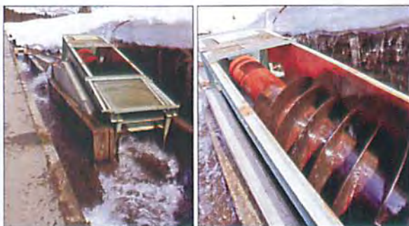
らせん型水車は、ごみが羽根の間を通り抜けていく
